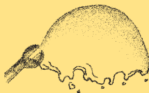
2. VANDKUGLE. En dyse der udsender en halvcirkulær vandhinde. Tyngdekraften er ikke stærk nok til at splintre vandet, men får strålen til at krumme nedad. Havhestefontænen i Borgheses Park, Rom.
